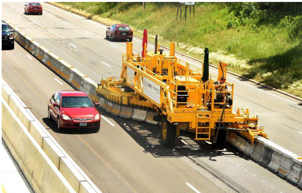
Рисунок 4.1 – Машина для перестановки барьеров «Road Zipper» (дорожная застежка-молния)
