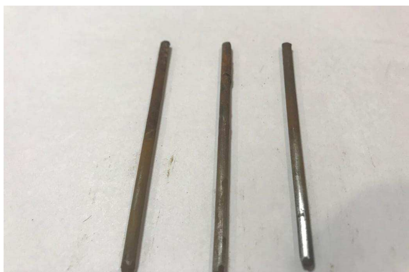
Рисунок 27 – Металлические штыри, извлеченные из исследуемых противогололедных реагентов: снег с песчано-соляной смесью, снег с «Бионордом» и снег (слева направо)
