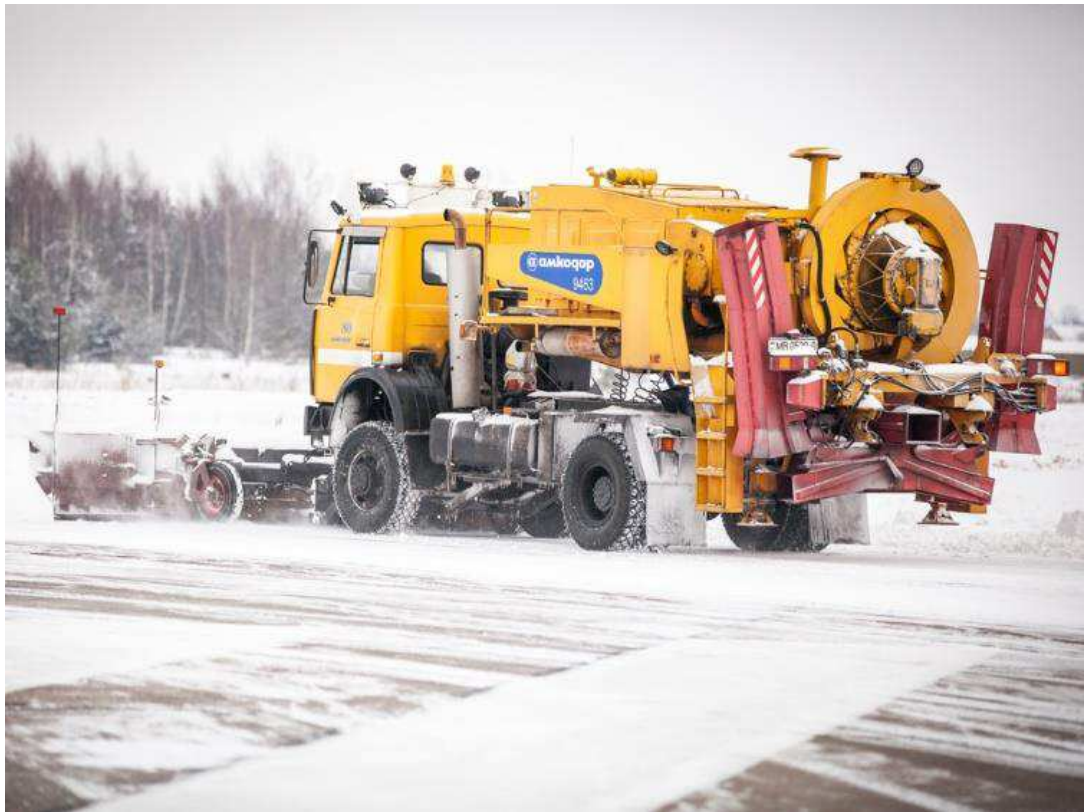
Рисунок 12 – Борьба с гололедом с помощью тепловой машины
