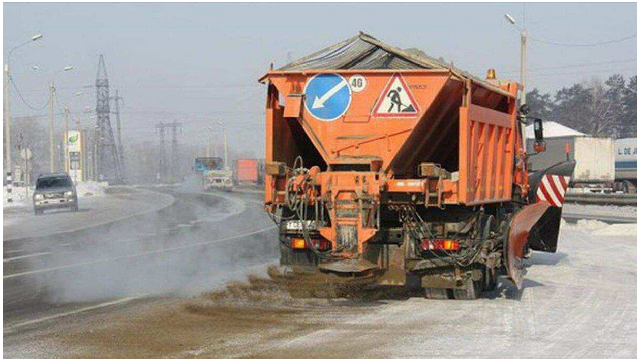
Рисунок 10 – Борьба с гололедом с помощью пескоразбрасывателей
