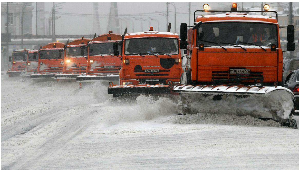
Рисунок 11 – Борьба с гололедом механическим способом
