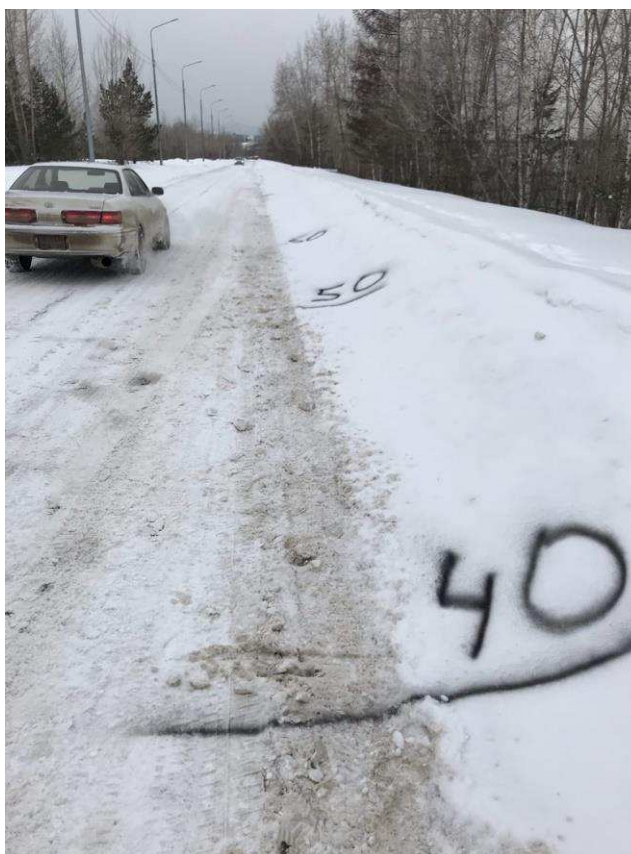
Рисунок 15 – Отметки окончания торможения при различных скоростях: 40 км/ч, 50 км/ч и 60 км/ч
