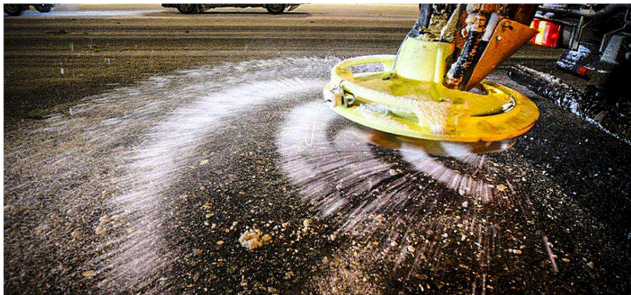
Рисунок 13 – Борьба с гололедом с помощью химического способа
