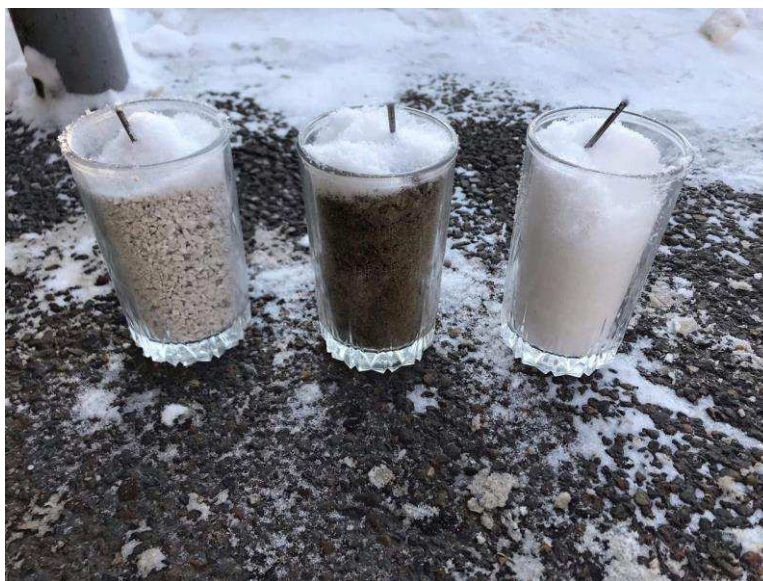
Рисунок 26 – Металлические штыри, погруженные в исследуемые противогололедные реагенты: снег с «Бионордом», снег с песчано-соляной смесью и снег (слева направо)
