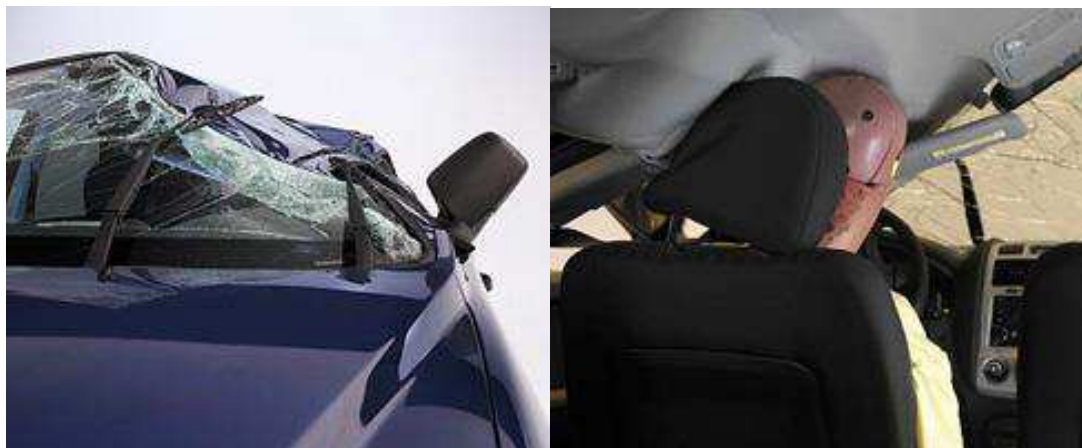
Рисунок 1.7 – Слабые стойки крыши и повреждение головы водителя
