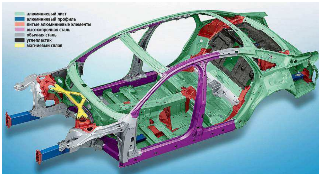
Рисунок 1.4 – Алюминиевый кузов Audi A8
