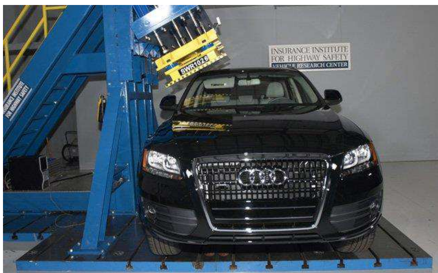
Рисунок 1.8 – Стенд проверки прочности крыши IIHS
