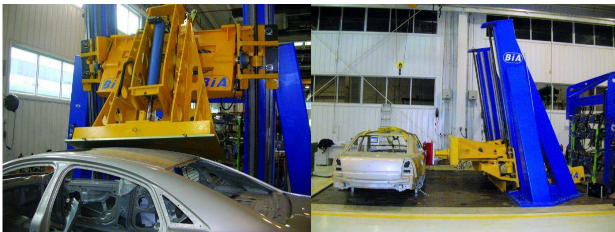
Рисунок 1.9 – Испытания прочности крыши и дверей
