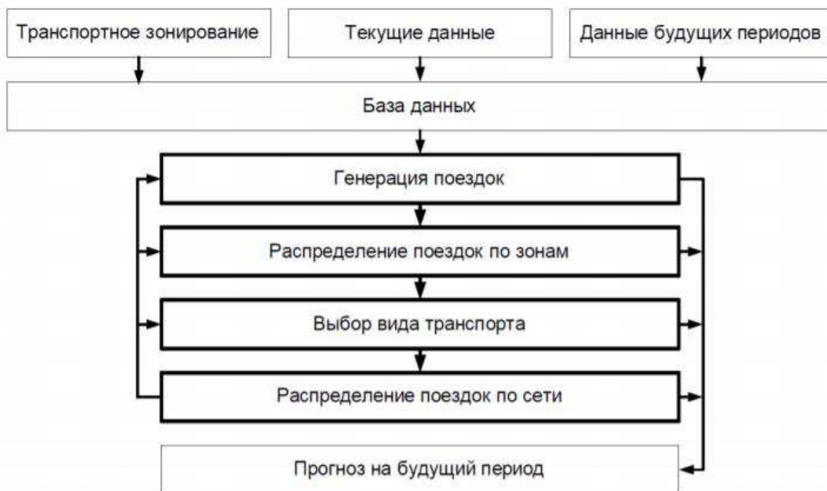
Рисунок 1 – Структура классической четырехшаговой модели расчета транспортного спроса
