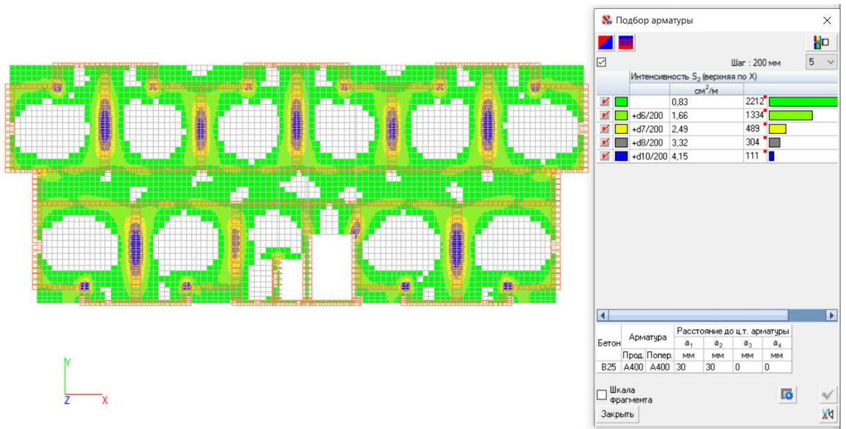
Рисунок 2.7 - Результат подбора арматуры верхней сетки по направлению оси X
