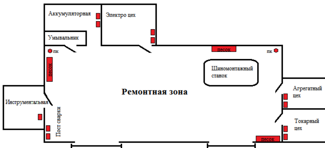
Рисунок 2 — Планировка ремонтной зоны
