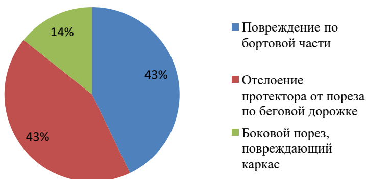
Рисунок 12 – Основные повреждения Мишлен 33.00.R51
