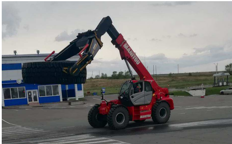
Рисунок 5 – Транспортировка КГШ погрузчиком Manitou
