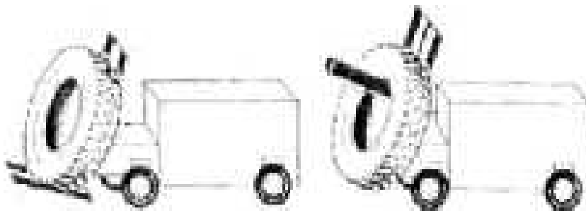
Рисунок 4 – Транспортировка шин погрузчиком с плоскими захватами.
