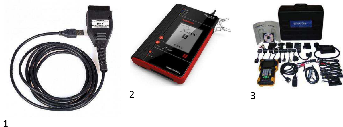
Рисунок 3.8 – Сканеры блоков управления двигателями и агрегатов 1 - програмно-аппаратный комплекс ДК-5; 2 - диагностический
