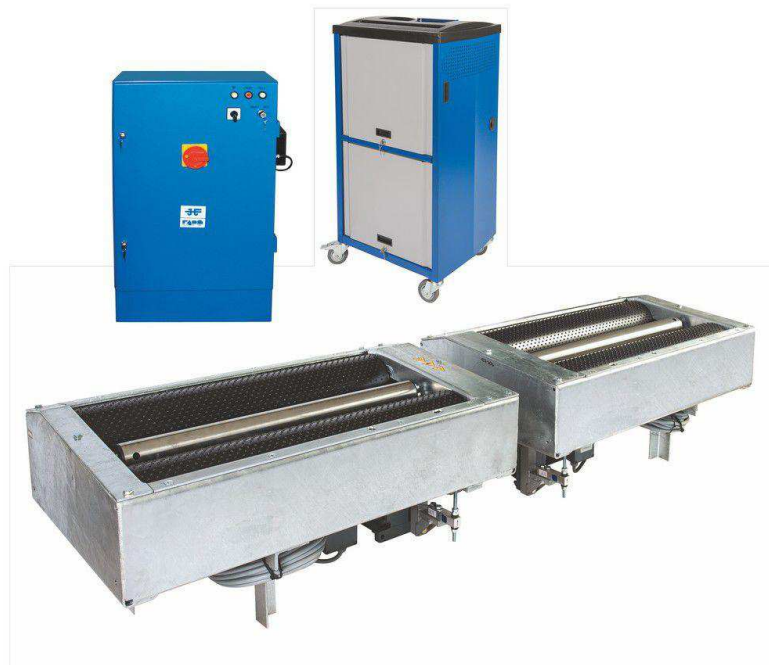
Рисунок 3.7 – Стационарный универсальный тормозной стенд СТС-10У-СП-11
