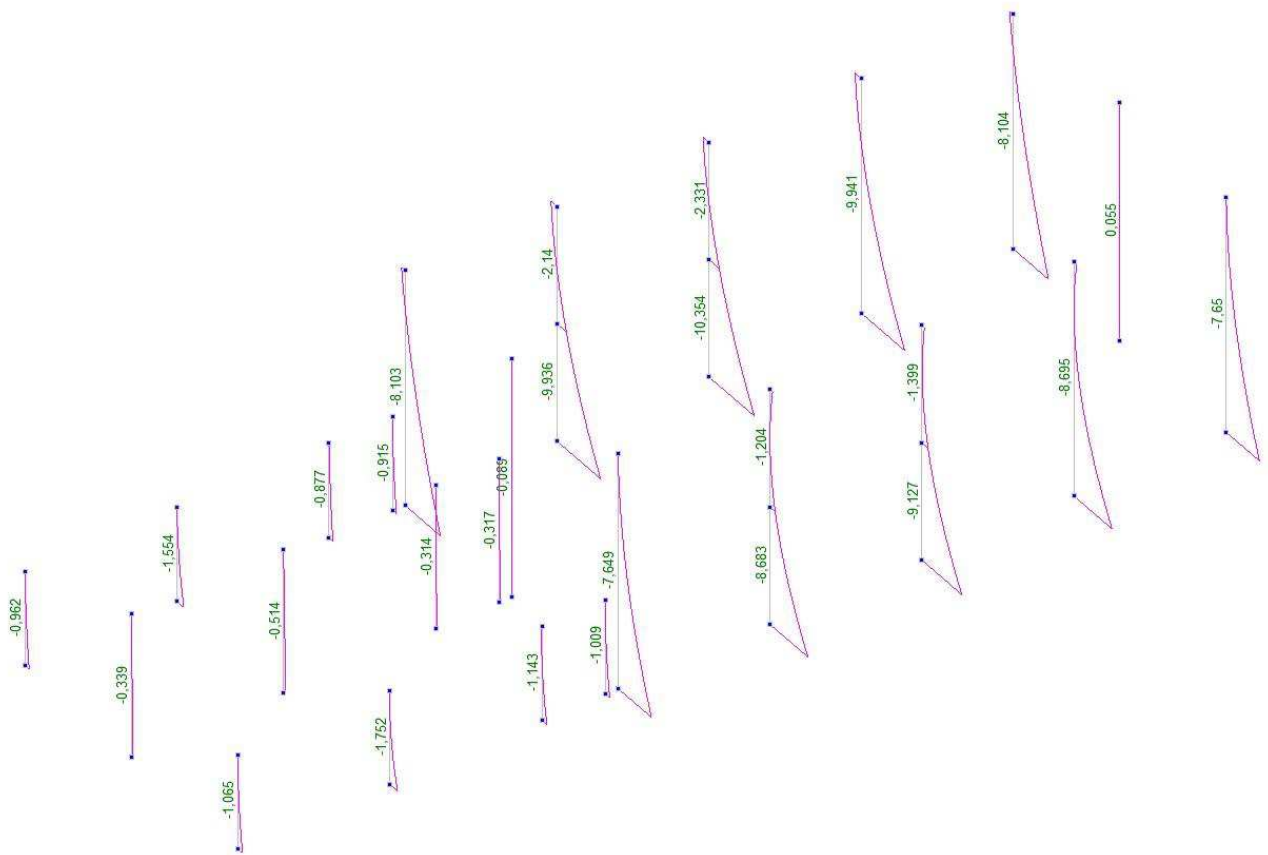
Рисунок 3.13. Эпюра изгибающих моментов Mu в колоннах, сочетание С3.
