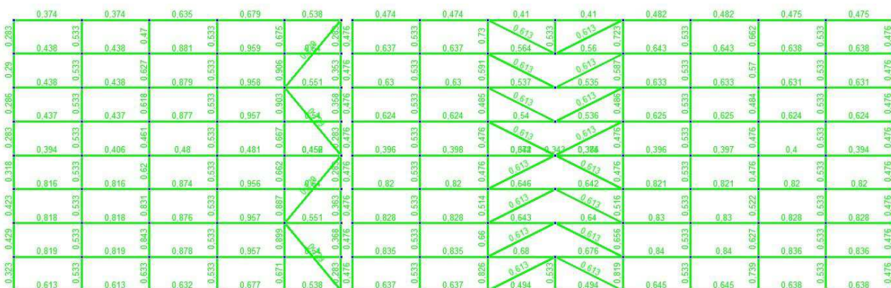
Рисунок 3.24. Коэф-ты использования сечений в уровне прогонов покрытия.
