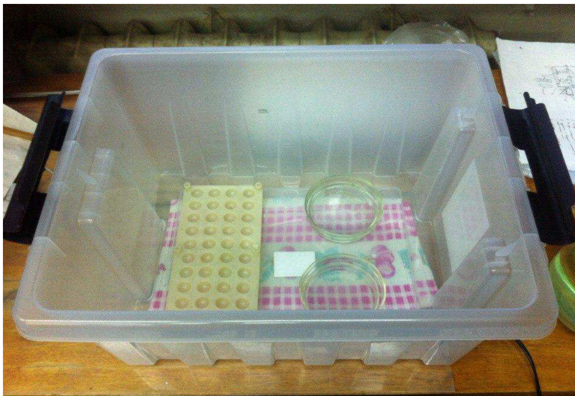
Рис. 1. Контейнер с пищевыми ячейками и установленными чашками Петри для выращивания хлореллы
