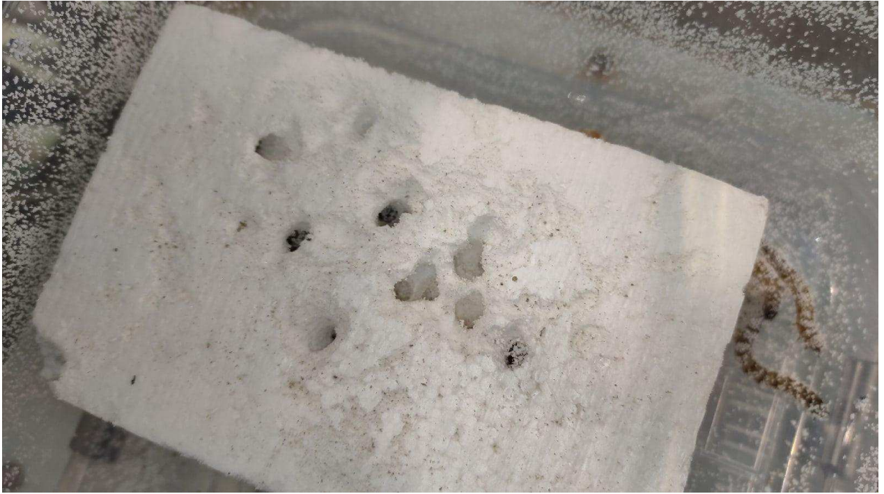
Рис. 7. Блок пенополистирола в конце эксперимента, на фото видно ходы, проделанные личинками внутри блока
