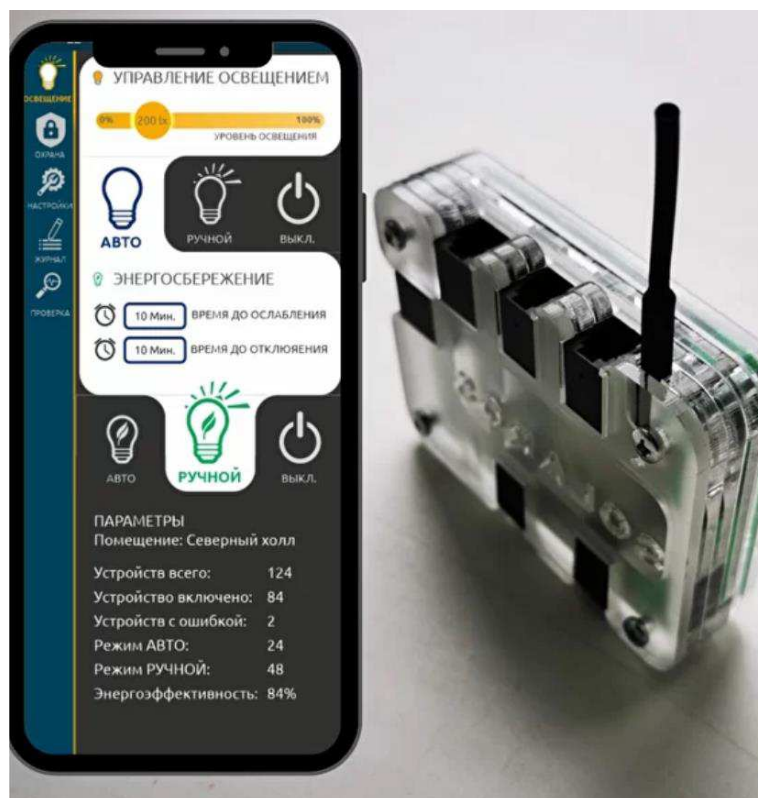
Рисунок 12 – Контроллер и программа управления «SolarOs» [15]
