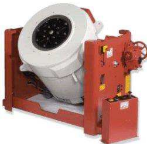
Рисунок 33 – Вибростенд LDSV8 – 440 для испытания бортовой РЭА
