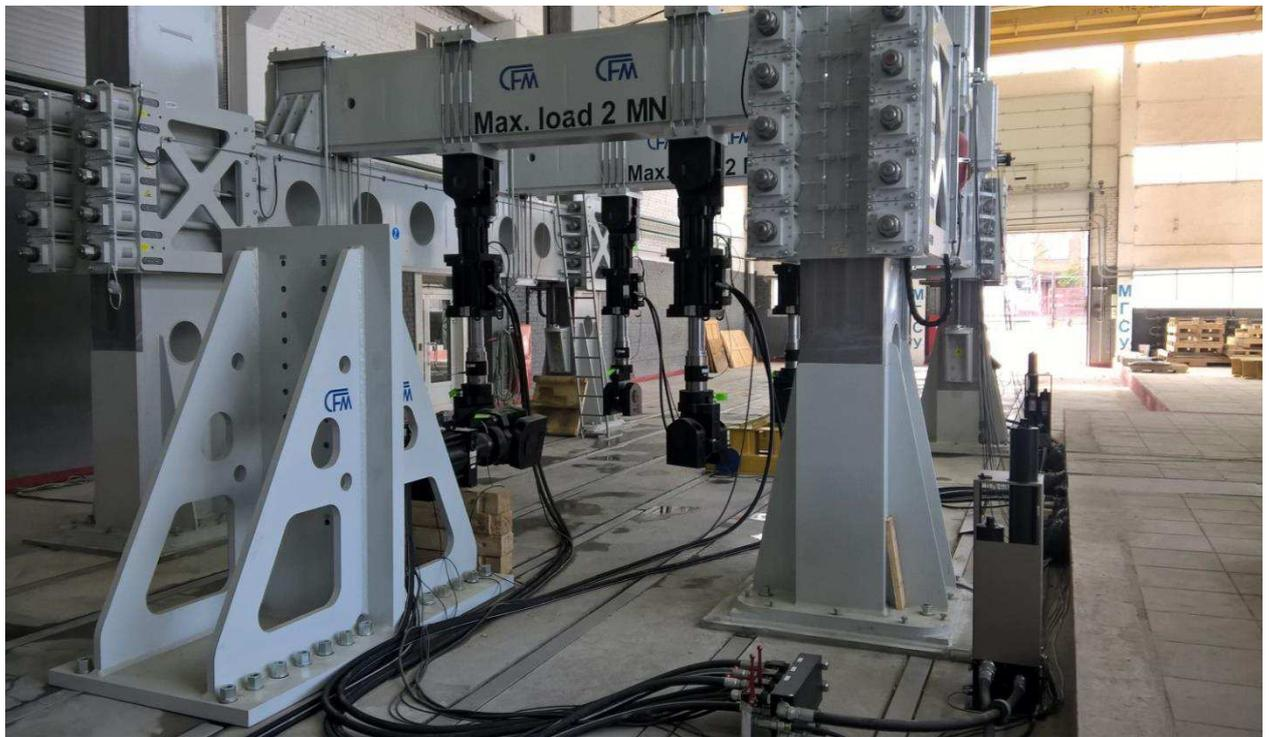
Рисунок 2.8 – Стенды статического испытания
