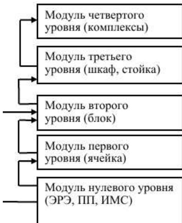
Рисунок 1.1 – Иерархия конструкционных систем
