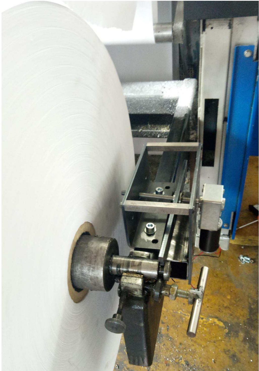
Рисунок 24 – Монтаж корпуса с мотор-редуктором
