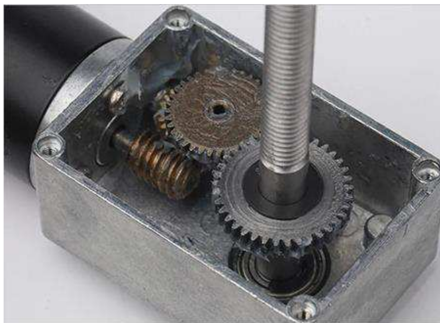
Рисунок 3 – Внутренние части червячного мотор-редуктора с приводным валом
