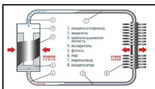
Рисунок 3.13 – Контурная тепловая труба
