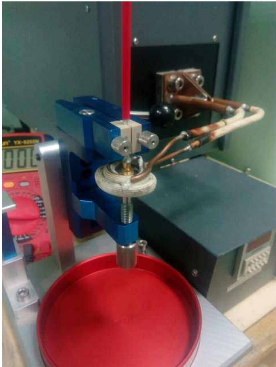
Рисунок 32 – Рабочая область установки для полуавтоматической заделки соединителей
