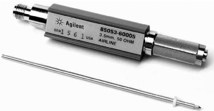
Рисунок 19 – Сегмент воздушной коаксиальной линии передачи
