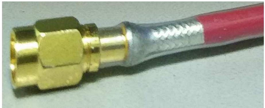
Рисунок 44 – Результат бесконтактной пайки корпуса соединителя
