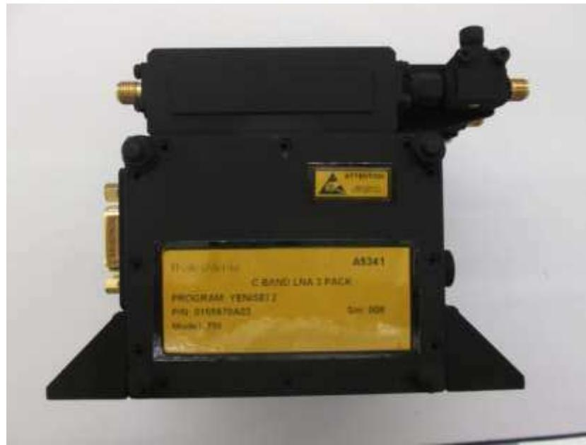
Рисунок 5 – Сборка МШУ С-диапазона (вид сбоку)
