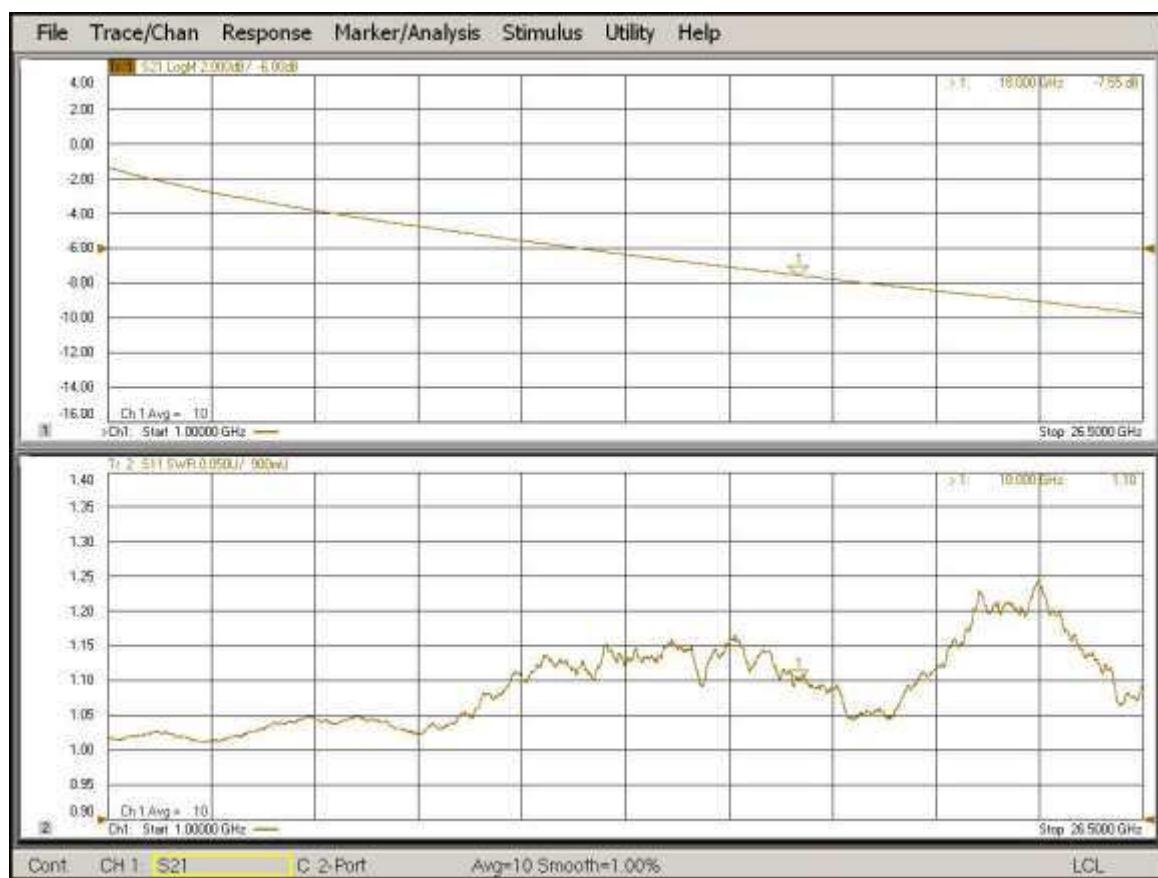
Рисунок 49 – Измеренные PTX кабельной сборки SRT-HF
