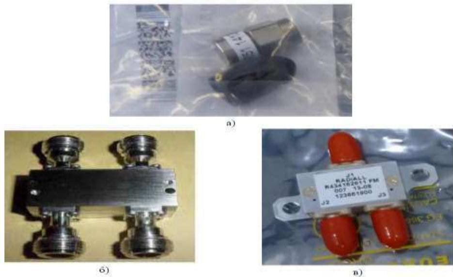
а) согласующая нагрузка; б) гибридное соединение; в) делитель мощности
