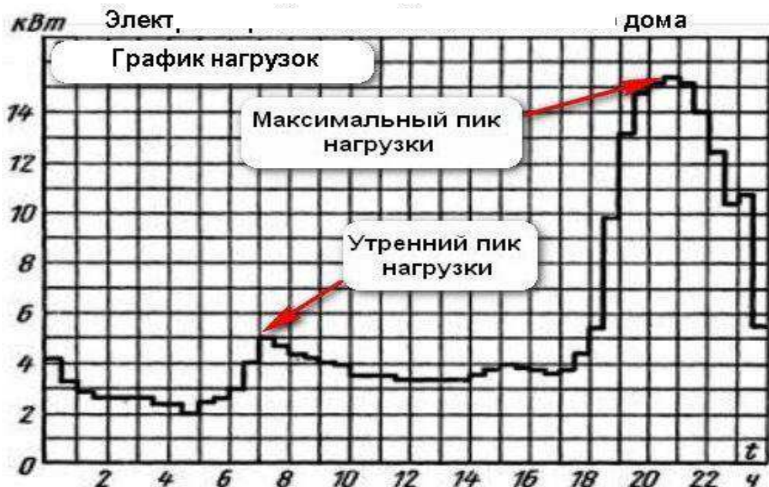
Рисунок 2.4 – График энергопотребления небольшого жилого дома.
