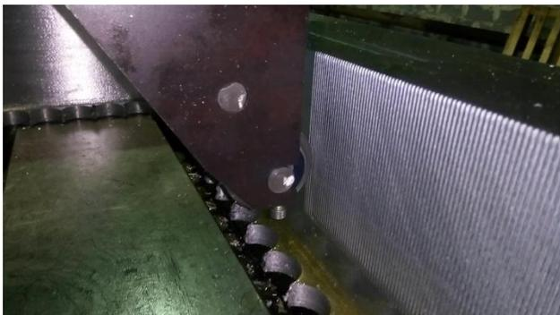
Рисунок 6. Накатка внутренней поверхности кристаллизатора
