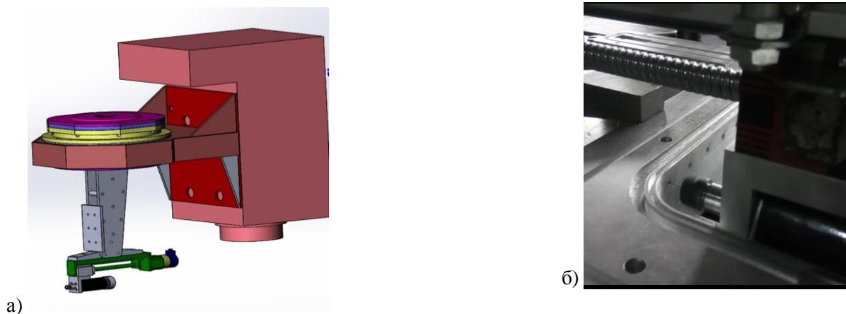
Рисунок 7. Вариант использования шпиндельной головки с осями XYZCW: 3D-модель (а) и процесс сверления жиклеров (б)
