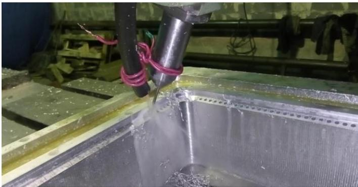
Рисунок 4. Сверление отверстий в кристаллизаторе методом пространственных приращений
