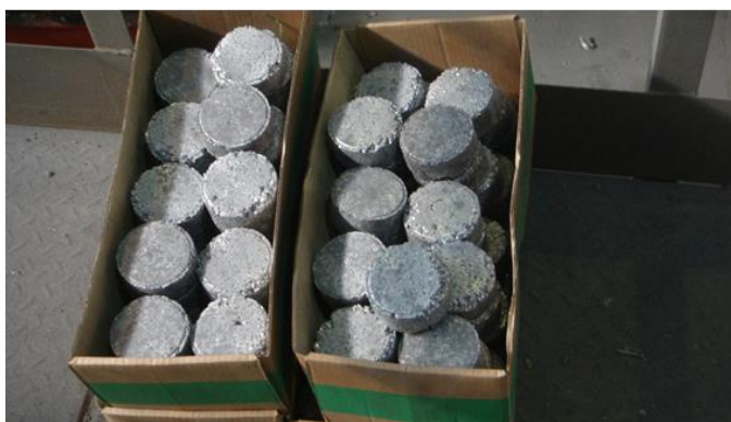
Рис. 3 – Брикетированная лигатура на рабочей площадке установки ЭП
