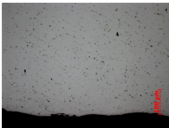
Рис. 4. Микроструктура сварного шва сплава I после МКК ( \times 200 )
