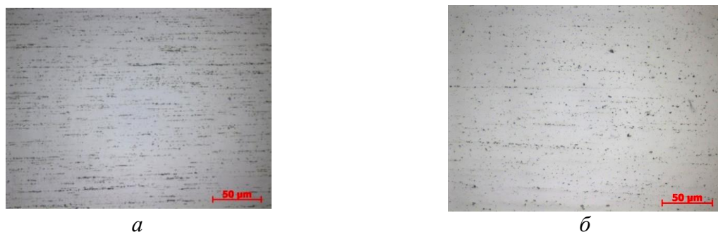
Рис. 5. Микроструктура прутков диаметром 9 мм из сплава 1 (а) и 2 (б) в деформированном состоянии ( \times 500 )
