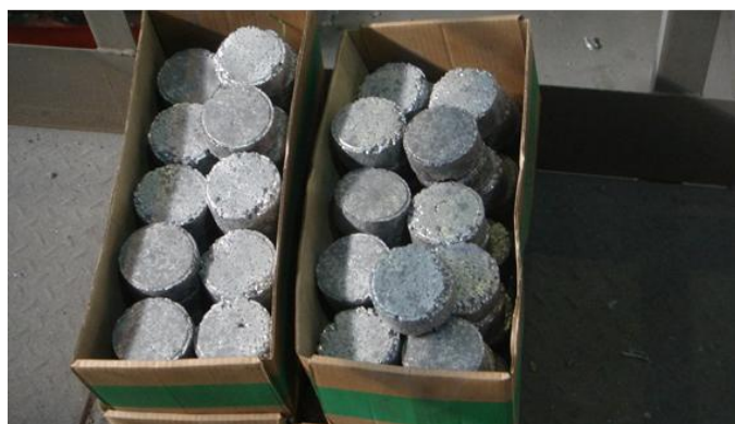
Рис. 3 – Брикетированная лигатура на рабочей площадке установки ЭП
