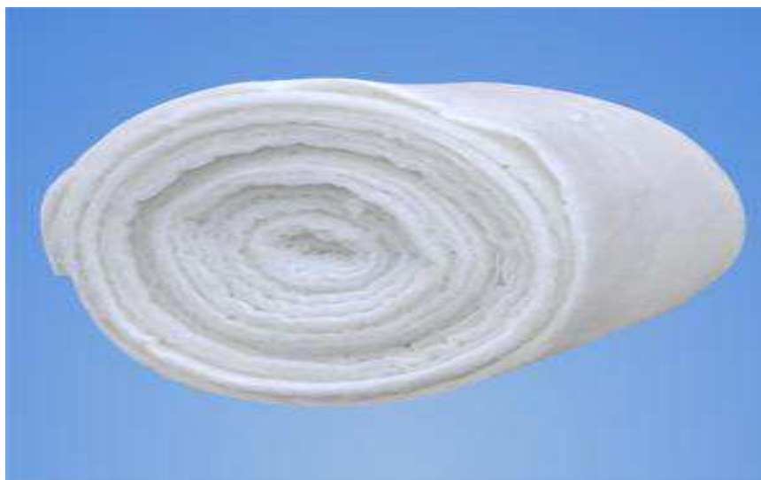
Рисунок 6 – Волокнистый сорбент в форме полотна для сбора нефтепродуктов
