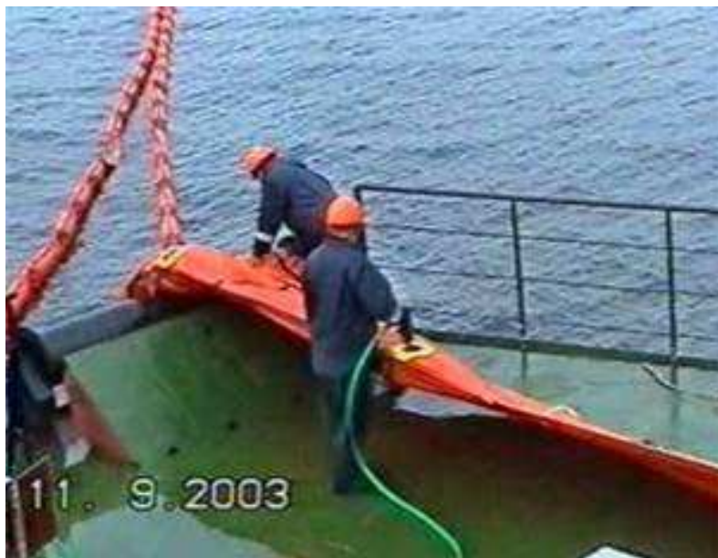
Рисунок 13 – Развертывание аварийных боновых заграждений
