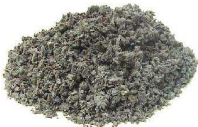
Рисунок 4 – Гидрофобный сорбент для сбора нефтепродуктов
