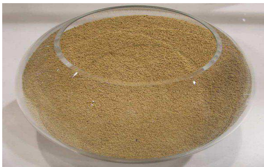
Рисунок 5 – Сорбент для сбора нефтепродуктов и жидких химических веществ
