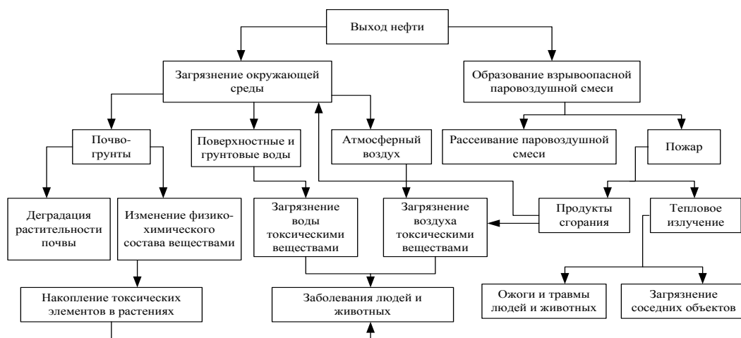
Рисунок 22 – Дерево событий, возникающих в результате аварии на МН при разливе нефти
