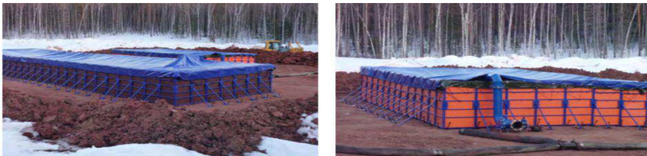
Рисунок 9 – Ёмкости временного хранения нефти/нефтепродуктов серии «ВХН-Ку»
