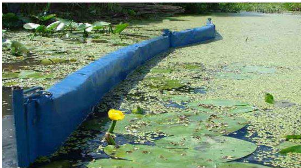
Рисунок 15 – Применение универсальных боновых заграждений на болоте
