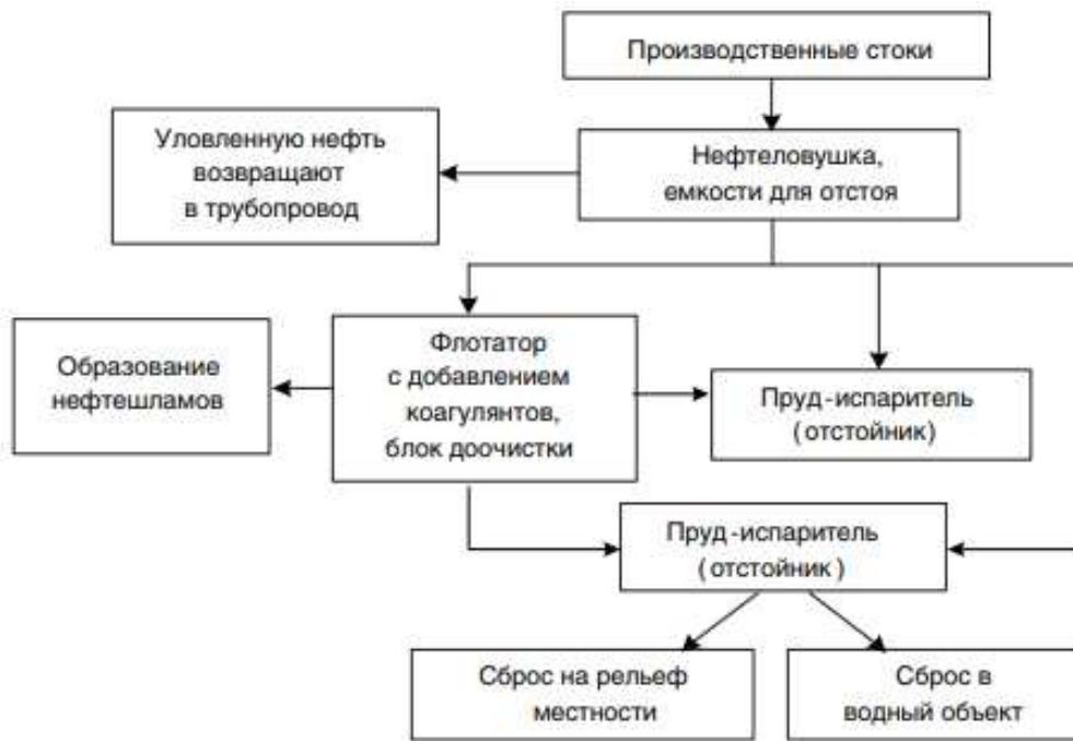
Рисунок 21 – Технологическая схема очистки производственных вод
