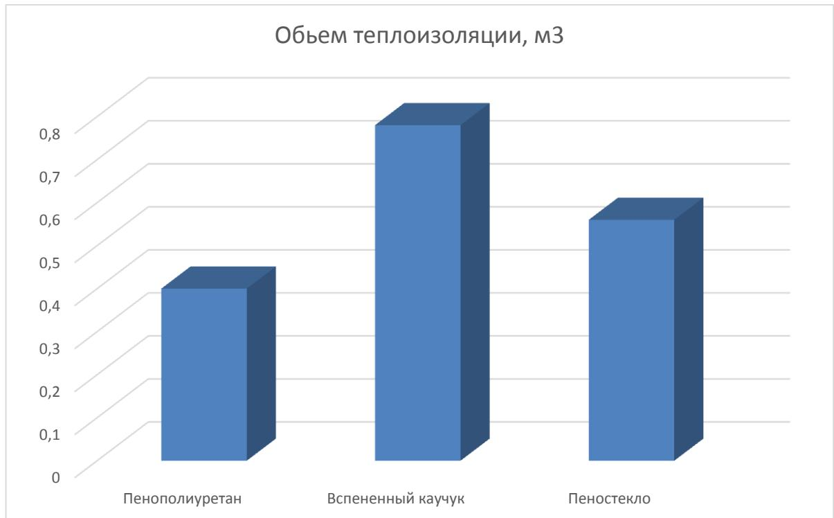
Рисунок 19 — Сравнительная диаграмма теплоизоляционных материалов по объему на монтаж участка
