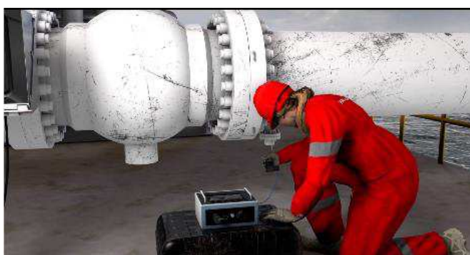
Рисунок 14 – Ввод датчика в трубопровод
