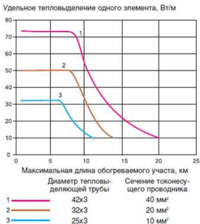
Рисунок 7 – Удельное тепловыделение одного элемента
