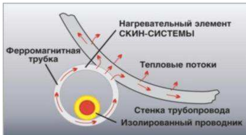
Рисунок 6 – Принцип действия нагревательного элемента СКИН-системы
