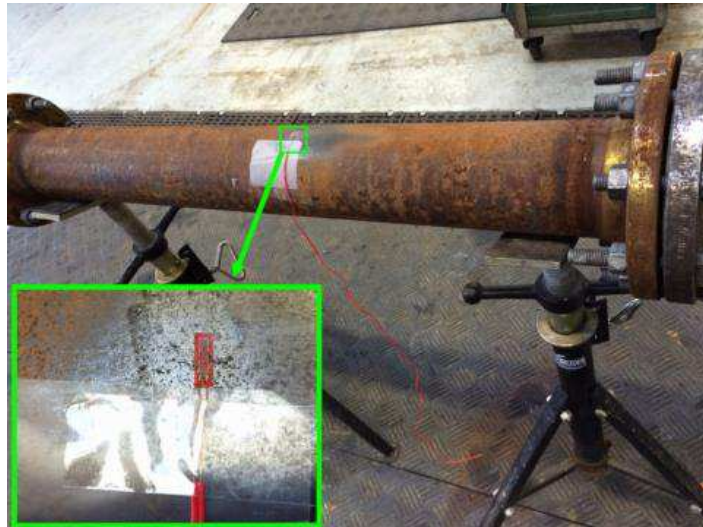
Рисунок 18 – Экспериментальная установка для определения деформаций в стенке трубопровода диаметром 102 мм
