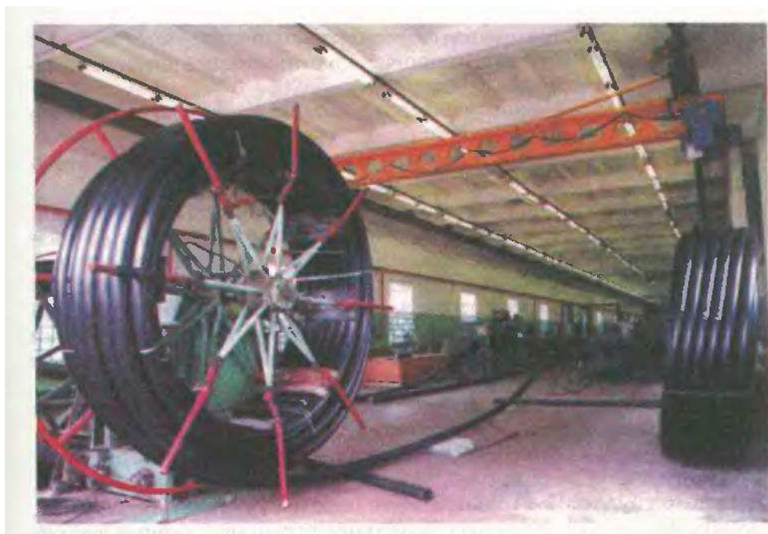
Рисунок 5 – Намотка ПЭТ на катушку
