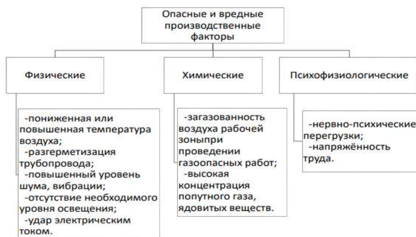
Рисунок 18 – Опасные и вредные производственные факторы, воздействующие на трубопроводчика линейного
