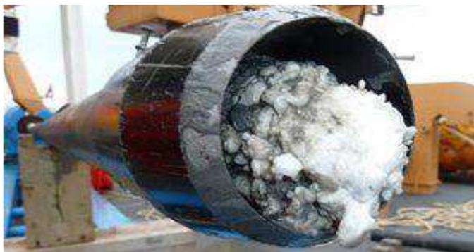
Рисунок 1 – Газогидратная пробка в трубопроводе
