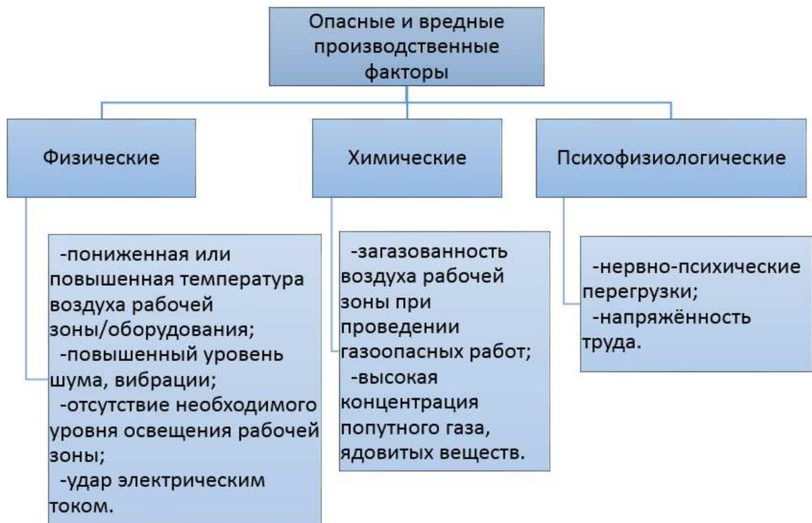
Рисунок 17 – Опасные и вредные производственные факторы, воздействующие на трубопроводчика линейного при выполнении работ при обслуживании линейной части трубопровода
