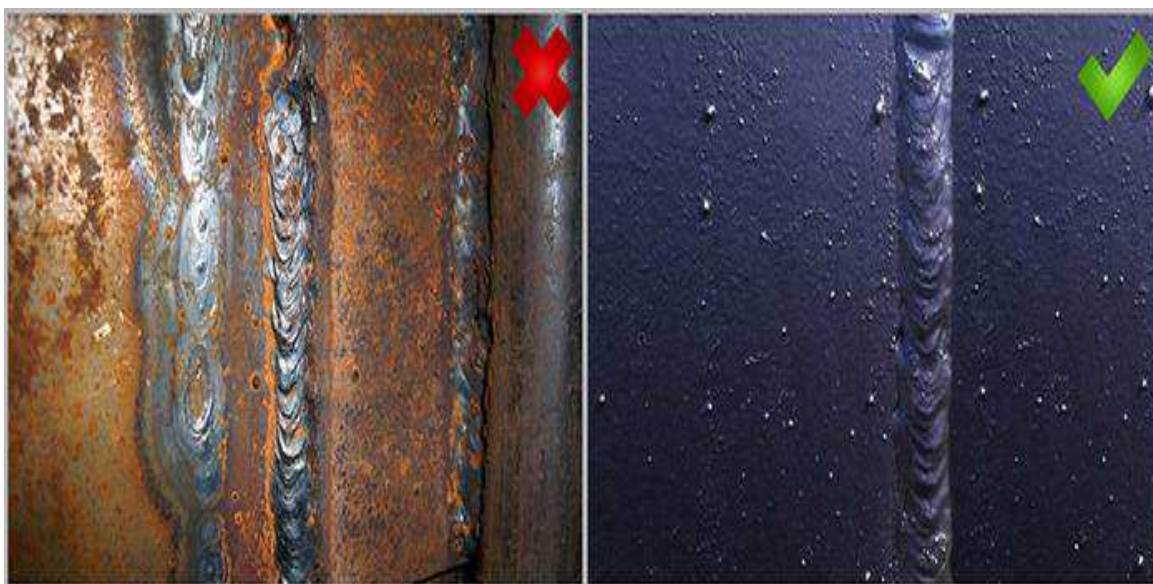
Рисунок 9– Эффект от антикоррозийного покрытия шва
