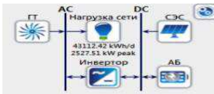
Рисунок 10.2 – Мнемосхема энергетического комплекса в ПК Homer Energy.
