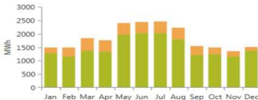
Рисунок 10.4 – Распределение выработки электроэнергии от МГЭС и СЭС
