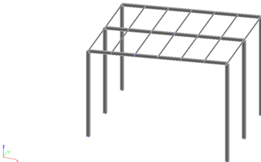
Рисунок 2.5 – Расчётная схема балок покрытия здания (Каркас с объёмом элементов)
