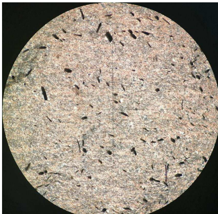
Рисунок 6 – Метасоматит хлорит–кварц–серицитовый. Гранолепидобластовая структура. Шлиф 1.1. Николи +. Ширина поля зрения 2.25 мм.
