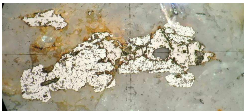
Рисунок 11 – Кварцевый метасоматит, руда на золото. Гипидиоморфнометазернистая структура марказита. Марказит – желтовато – белый. Полированный шлиф 2.9. Николи ||. Ширина поля зрения 1.125 мм.
