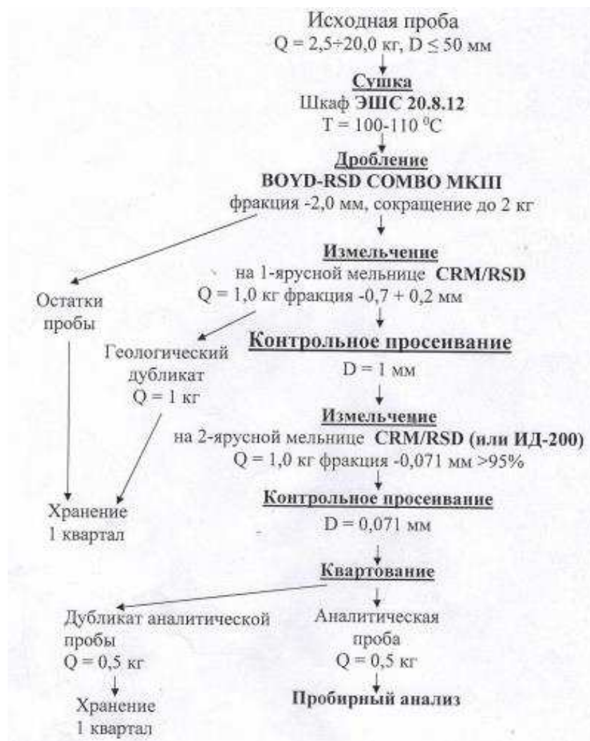
Рисунок 18 – схема пробоподготовки для пробирного анализа
