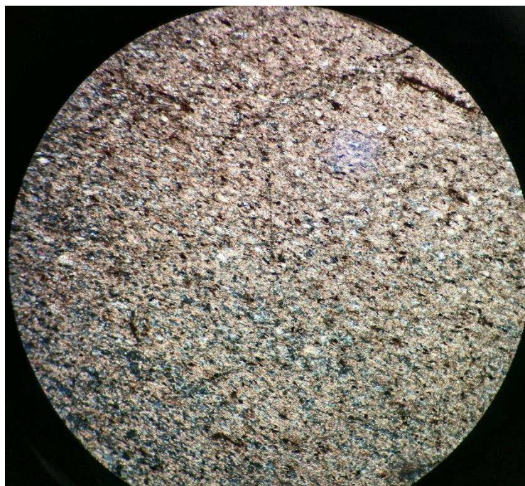
Рисунок 5 – Сланец серицит-кварцевый. Лепидогранобластовая структура. Шлиф 2.5. Николи +. Ширина поля зрения 2.25 мм.
