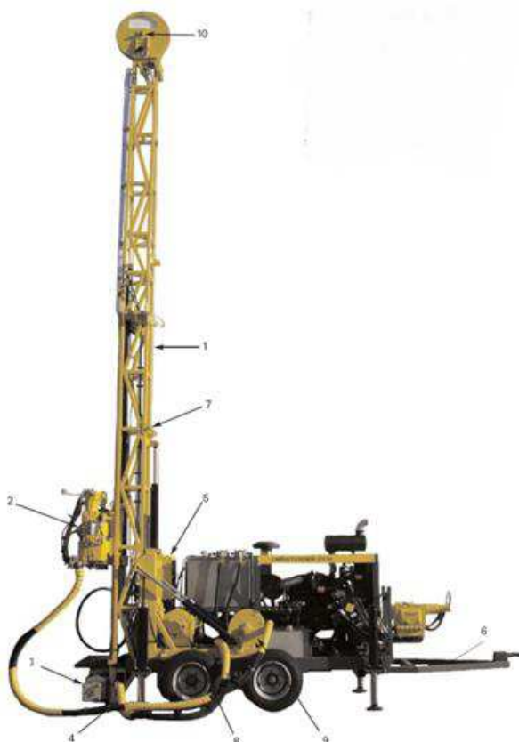
Рисунок 17 – буровая установка Atlas Copco Christensen CS – 14. 1 – подающая рама; 2 – вращатель; 3 – штангодержатель; 4 – опорная скоба; 5 – панель управляющих клапанов; 6 – шасси; 7 – скоба для обратных опор; 8 – главная лебедка; 9 – тросовая лебедка; 10 – кронблок.
