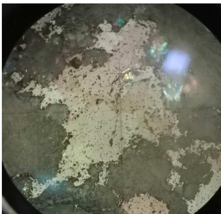
Рисунок 9 – Хлорит-кварц-серицитовый сланец. Гипидиоморфнометазернистая структура пирротина. Пирротин – кремовый. Полированный аншлиф 1.7. Николи +. Ширина поля зрения 2.25 мм.
