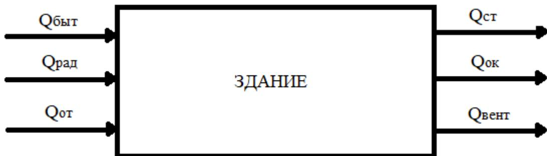
Рисунок 28 – Тепловой баланс здания
