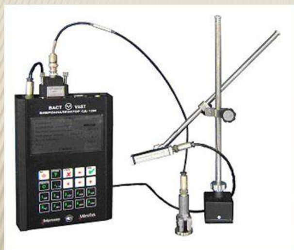
Рисунок 2. Виброанализатор СД - 21 с датчиком вибрации (вибропреобразователем) и датчиком углового положения вала (оборотов)
