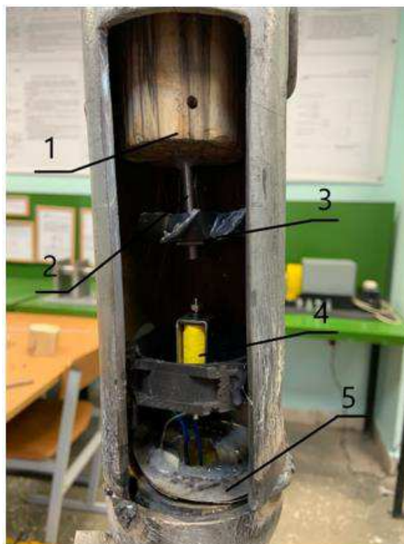
Рисунок 22 – Механизм управления бурового станка:
