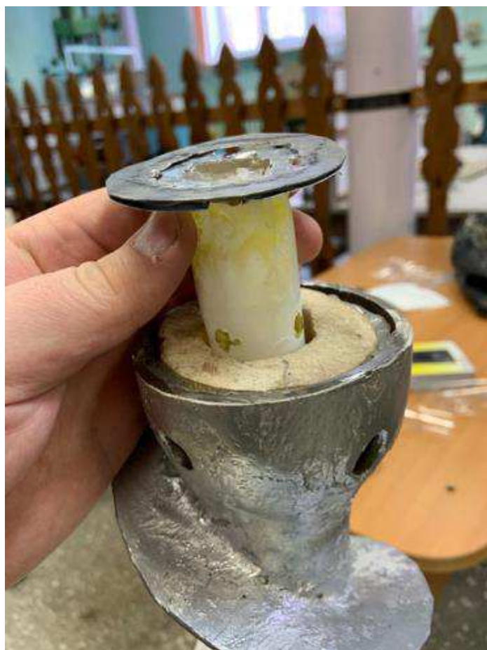
Рисунок 23 – Общий вид клапана с эжекционными отверстиями.
