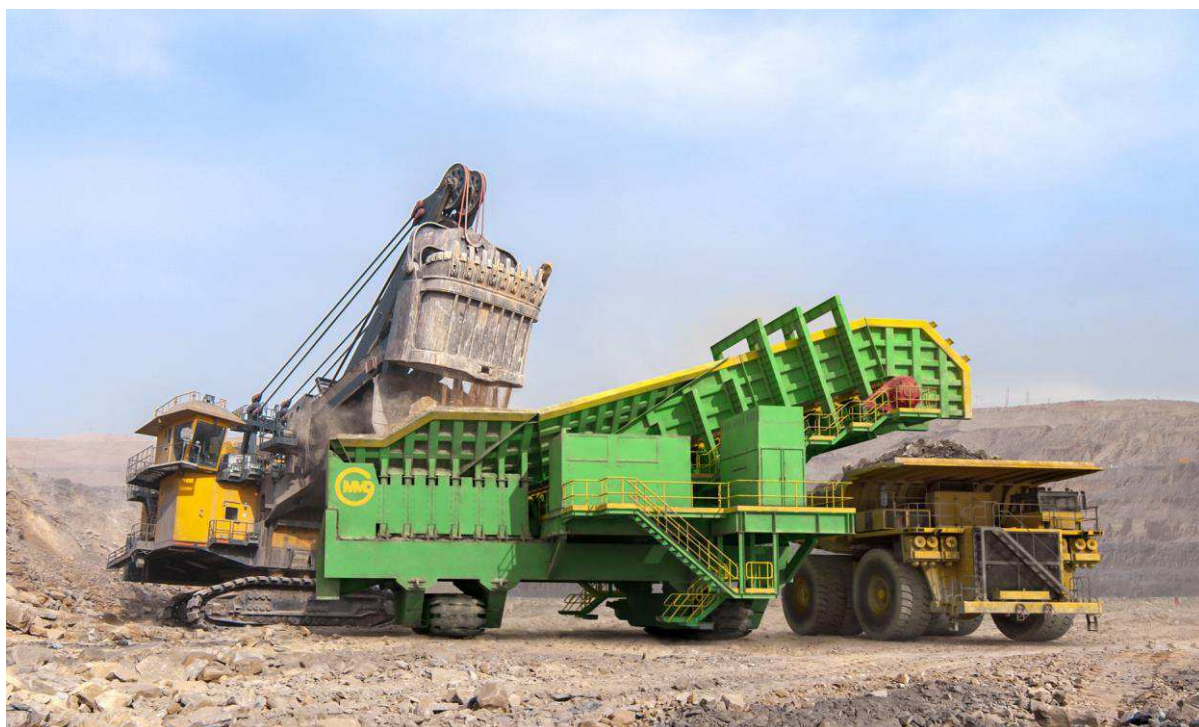
Рисунок - 6.3 Работа погрузочно-транспортного комплекса с применением мобильного перегружателя MMD
