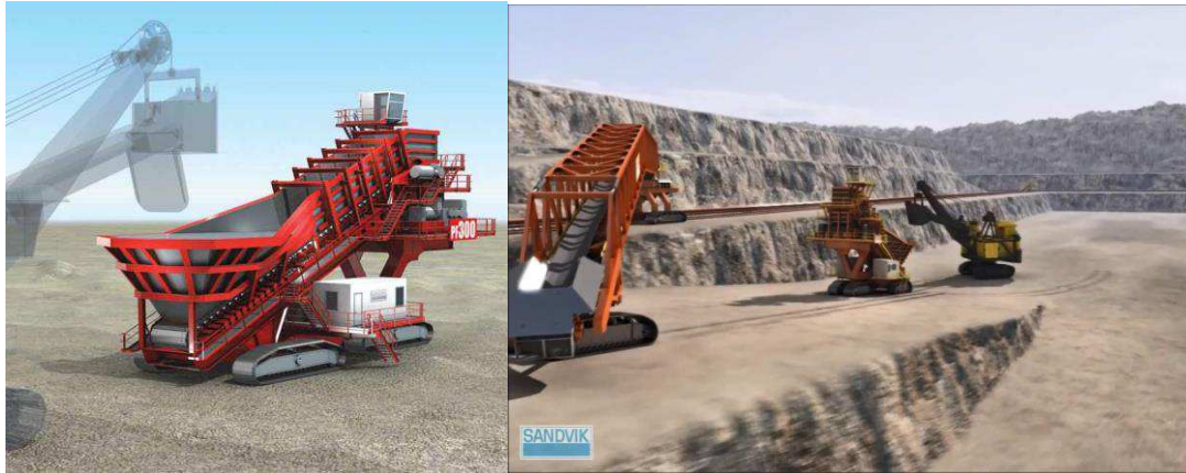
Рисунок - 6.4 Работа погрузочного транспортного комплекса с применением мобильного перегружателя Sandvik и оборудования непрерывного действия.
