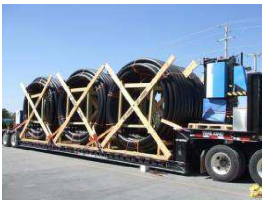
Рисунок 10 – Вид КМТ в бухте, готовой к транспортировке
