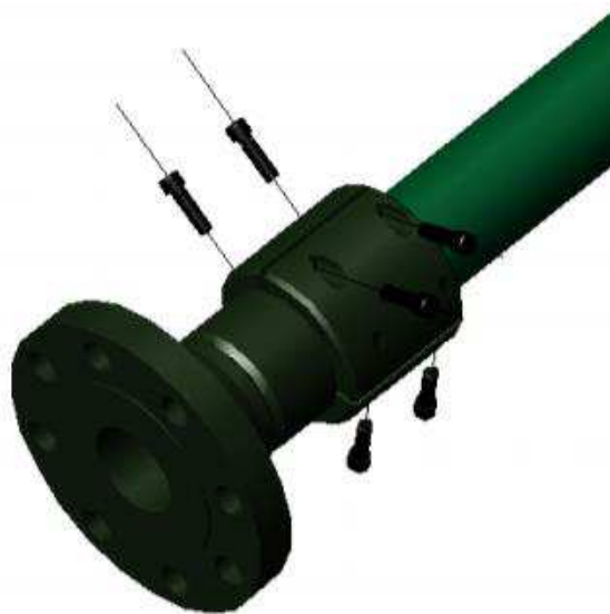
Рисунок 13 – Пример механического присоединения фланца к трубе
