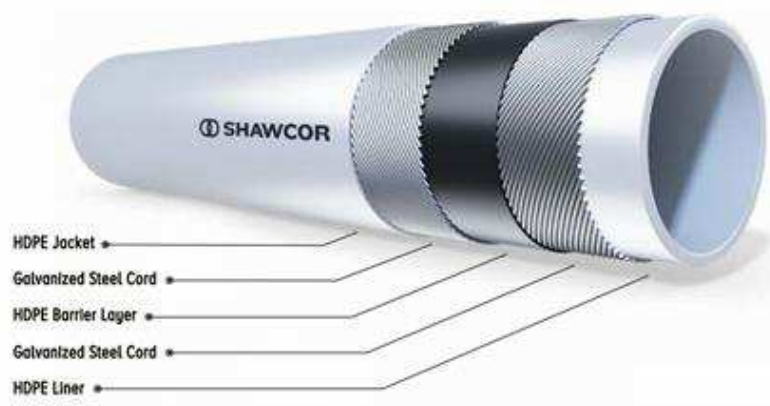
Рисунок 4 – Строение Flexcord
