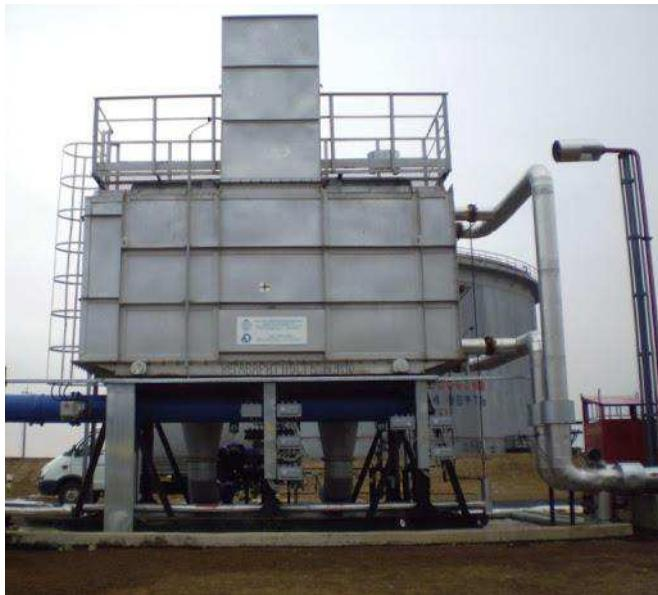
Рисунок 4 – Печь трубчатая блочная
