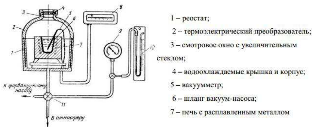
Рисунок 16 – Прибор для определения содержания H_2 в алюминиевых сплавах методом «первого пузырька»
