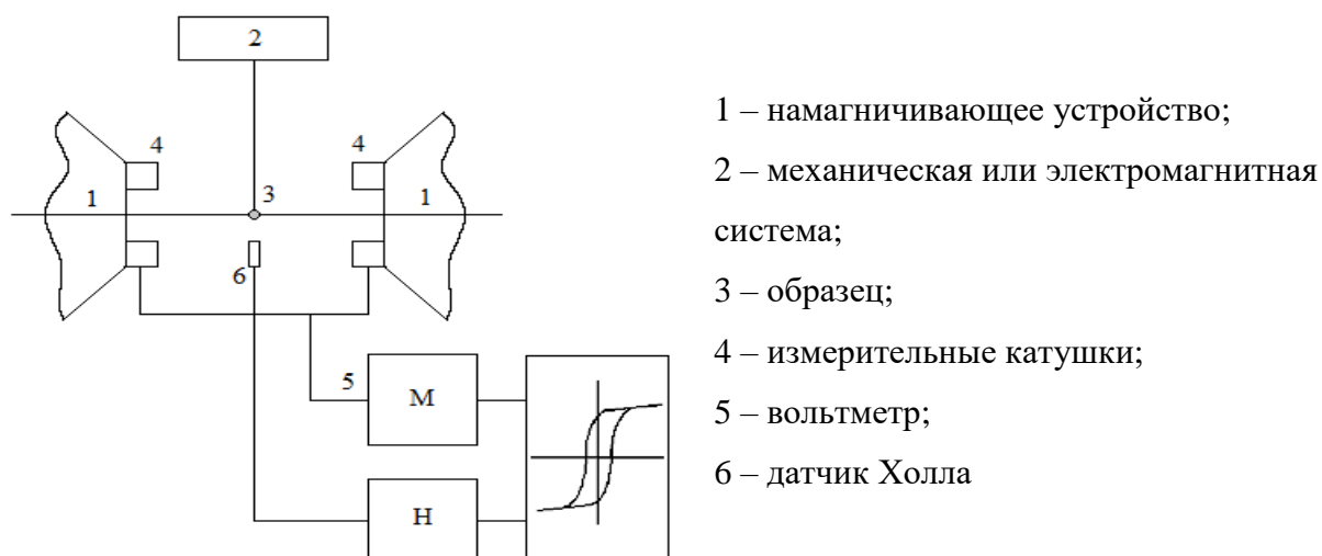
Рисунок 6 – Блок-схема вибрационного магнитометра
