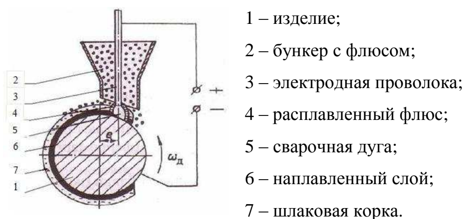
Рисунок 7 – Наплавка цилиндрической детали под слоем
