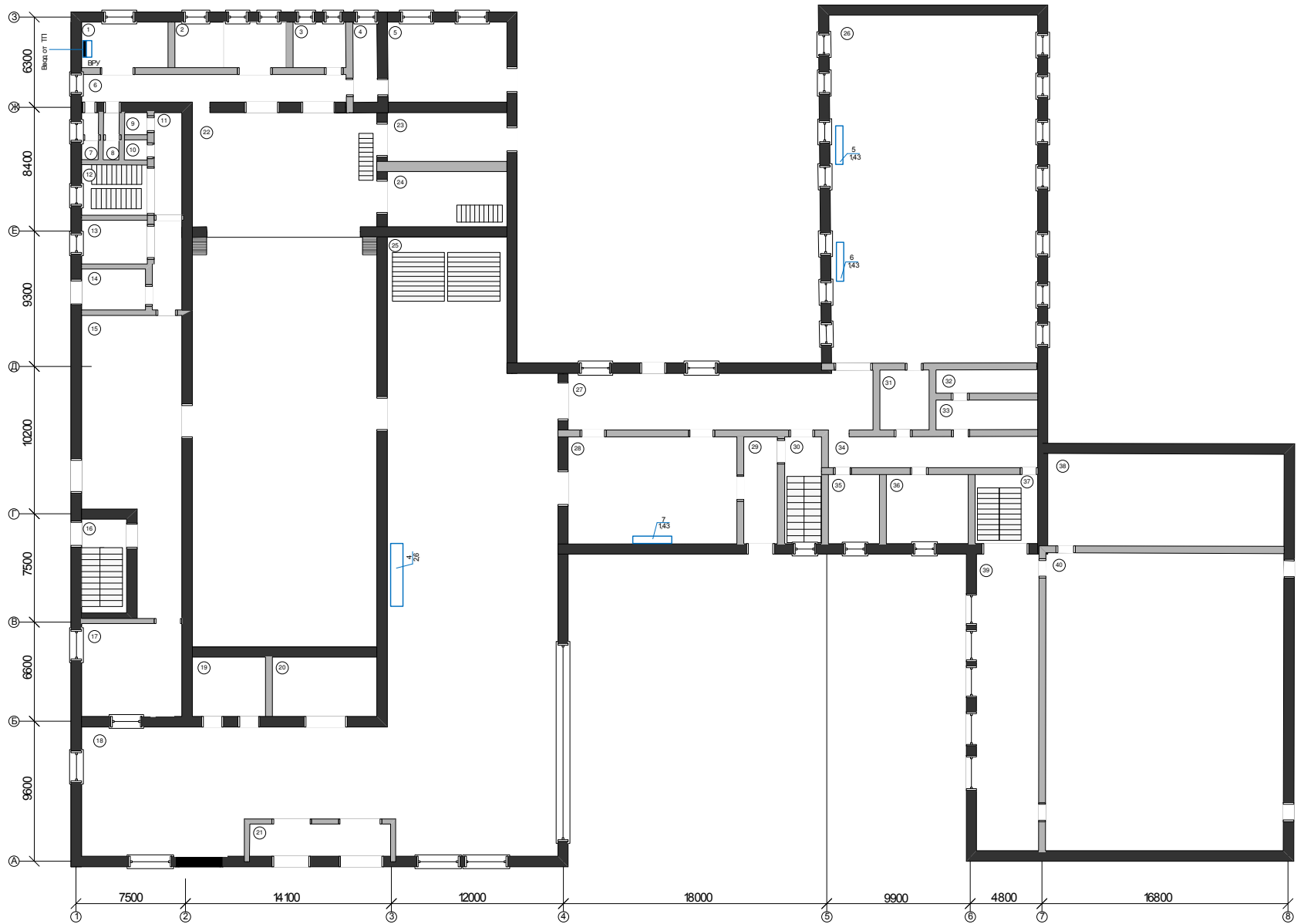
Рисунок 2.4 – План размещения основного силового оборудования здания ЦКиД, 1 этаж
