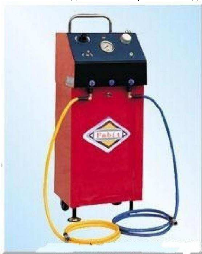
Рисунок 3.11 – Установка для замены антифриза LQ-747
