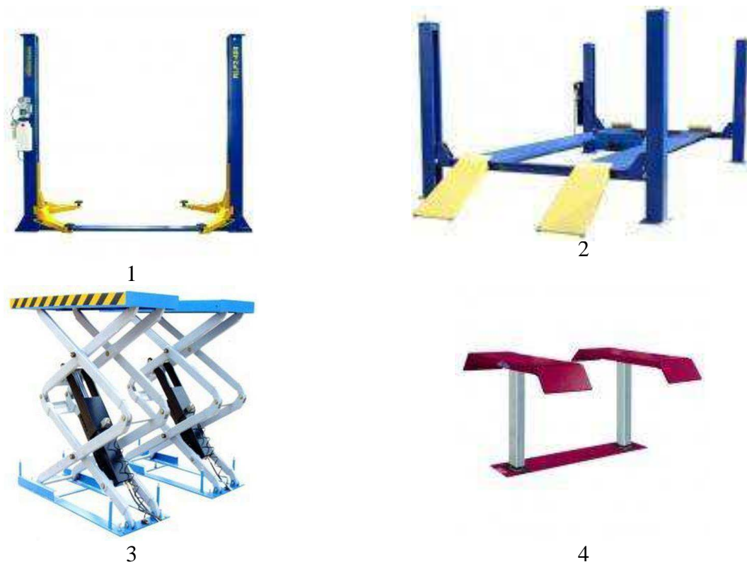
Рисунок 3.12 – Основные виды подъемников: 1 – двухстоечный; 2 – четырехстоечный; 3 – ножничные; 4 – плунжерные
