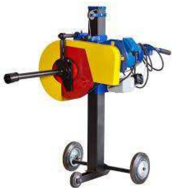
Рисунок 3.9–Гайковерт Г-120
