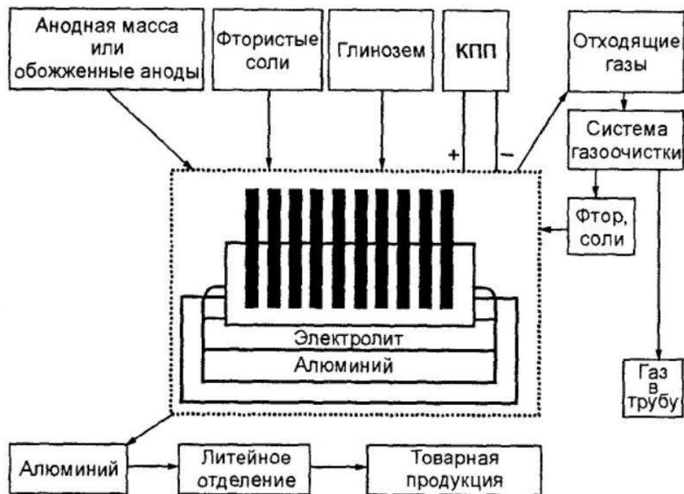
Рисунок 1 – Схема производства алюминия из глинозема
