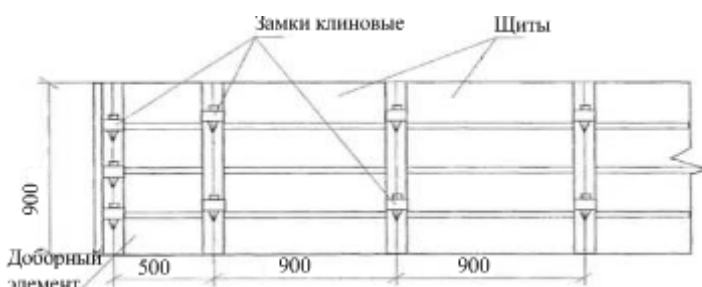
Рисунок 4.5 - Схема соединения щитов опалубки
