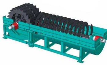
Рисунок 11 – Эскиз пескомойки КМ ПМГК-180-00
