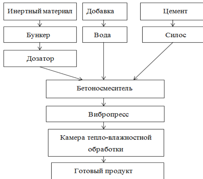
Рисунок 5 – Функциональная схема тротуарных плит способом вибропрессования
