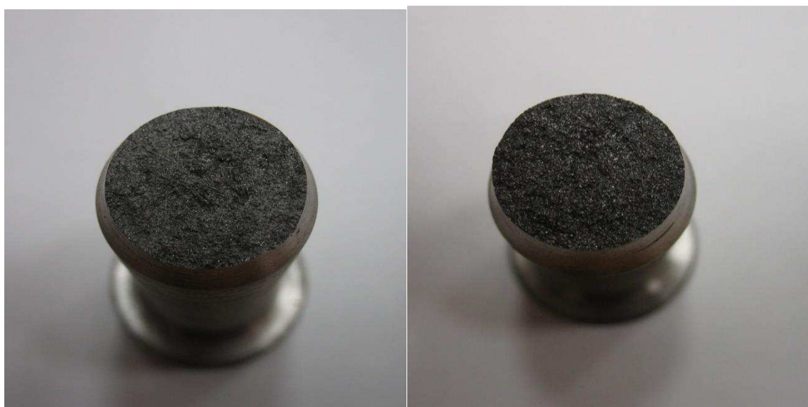
Рисунок 5 – Вид зерна чугуна в месте разрыва: модифицированный чугун (более мелкое зерно) (а), чугун – свидетель (более крупное зерно) (б)
