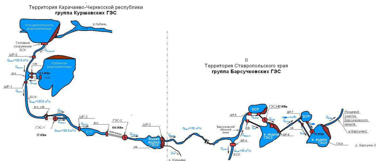
Рисунок 2.1 – Схема водохозяйственных связей
