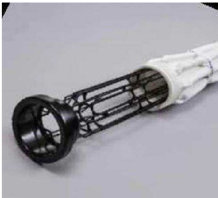
Рисунок 4 – Конструкция фильтровальных рукавов с увеличенной площадью фильтрации
