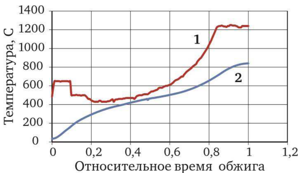
Рисунок 11 – Температурный график обжига заготовок (1 – температура под сводом, 2 – температура заготовок)
